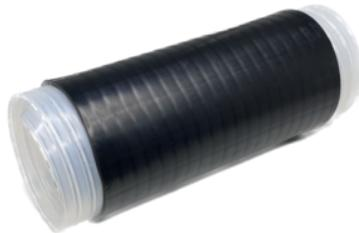
7/16 DIN,Nコネクタ用の常温収縮チューブです。機器接続部が常温収縮チューブのみで防水施工完了します。端末部のテープ巻き付けが不要で施工が簡単になり、作業性が大幅アップ。耐傷性も優れています。適合ケーブルは10D,20Dです。1箱(100本入)とバラ(1本)で販売可能です。
