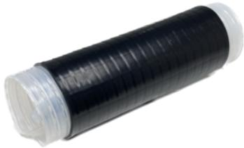
4.3/10,Nコネクタ用の常温収縮チューブです。機器接続部が常温収縮チューブのみで防水施工完了します。端末部のテープ巻き付けが不要で施工が簡単になり、作業性が大幅アップ。耐傷製も優れています。適合ケーブルは8D,10Dです。1箱(100本入)とバラ(1本)で販売可能です。
