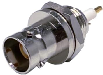
トライアキシャル・ケーブル用コネクタ、バルクヘッドタイプのレセプタクルです。トライアキシャル・ケーブルは三重同軸とも呼ばれ、ノイズに強い製品です。BNCコネクタと嵌合部が似ておりますが、嵌合は出来ません。本体は黄銅にニッケルメッキ。取付可能な最大パネル厚は3.0mm。ターミナル形状はソルダータイプになります。
