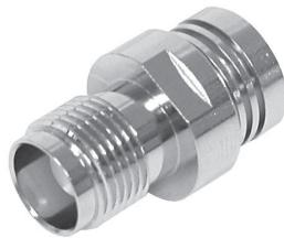
5D-FB、5D-FB-LITEケーブルに適合するIPX7防水仕様のTNC型ストレートジャックです。中心コンタクトは、5D-FBでは圧着、5D-FB-LITEでは半田タイプになります。圧着にはTA-24Sが必要です。
