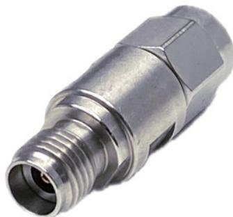
SMAコネクタとも嵌合互換性のある、2.92mm Kジャックと3.5mmプラグの変換コネクタ。本体はステンレスにパッシベイト処理。最大34GHzまで対応しています。
