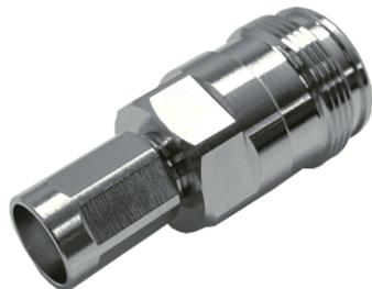
4Gおよび今後の5Gネットワーク向けのNXTPコネクタ(4.3/10型と比較して約50%の大きさ)と4.3/10型コネクタの変換コネクタ。本体は黄銅に三元メッキ。最大6GHzまで対応しています。規格「IEC 61169-71」に準拠して製造された他社製NEX10コネクタとも、嵌合可能です。エリクソン・ノキアなどの無線通信機器において、ポートがNEX10コネクタの場合も、問題無く嵌合出来ます。
