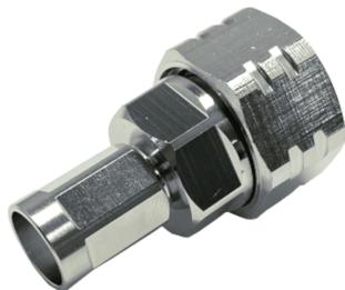
4Gおよび今後の5Gネットワーク向けのNXTコネクタ(4.3/10型と比較して約50%の大きさ)と4.3/10型コネクタの変換コネクタ。本体は黄銅に三元メッキ。最大6GHzまで対応しています。規格「IEC 61169-71」に準拠して製造された他社製NEX10コネクタとも、嵌合可能です。エリクソン・ノキアなどの無線通信機器において、ポートがNEX10コネクタの場合も、問題なく嵌合出来ます。
