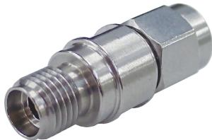
SMAコネクタや3.5mmとも嵌合互換性のある、2.92mm KコネクタジャックとSMAプラグの変換コネクタ。本体はステンレスにパッシベイト処理。最大26.5GHzまで対応しています。
