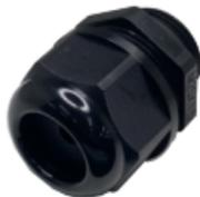
汎用コネクタを防水する、ケーブルグランドシリーズです。中継アダプター、CG25A-105と組み合わせて使用頂けます。適応電線サイズ:6.5~4.5mm、コネクタ寸法:φ19mmとなります。
