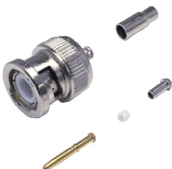
潤工社製、低雑音同軸ケーブルDFL030に適合するBNC型ストレートプラグです。本体が圧着タイプ、中心コンタクトは半田タイプ。取付加工には圧着工具TA-17が必要です。
