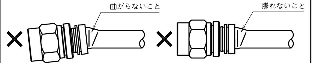
シェルを同軸ケーブルの外部導体と銅箔の間に真っ直ぐ入るように装着し
