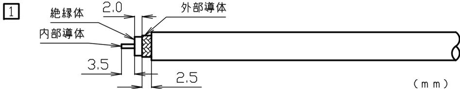
同軸ケーブルを図中の寸法で切り取る。
