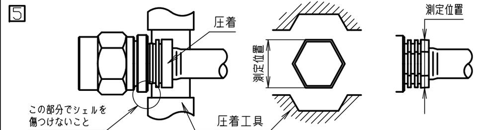
スリーブ部を圧着工具のBの部分で圧着させ作業を完了する。
