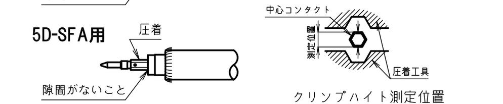
中心コンタクトを内部導体に装着し圧着工具Aの部分で圧着する。
