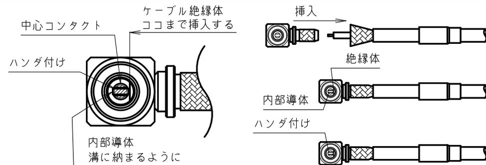
2 シェルを同軸ケーブルの絶縁体と外部導体の間に挿入する。このとき、内部導体が中心コンタクトの溝に収まるように挿入し、絶縁体が中心コンタクトに当たるところまで入れる。中心コンタクトと内部導体に対してハンダ付けをして、手で引っ張り 抜けない事を確認する。
