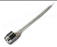
内部配線用ハンドフォーミングケーブルです。 セミリジットケーブルの置換で容易に曲げ可能。 ほとんどの高周波コネクタの取付が可能です。 片側芯線出しで基板直付けケーブルに適します。 周波数~40GHz対応
