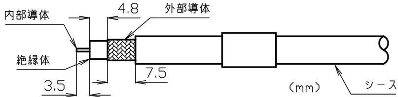
① 同軸ケーブルへ圧着スリーブを通し、シース、絶縁体、外部導体を図中の寸法で切りとる。
