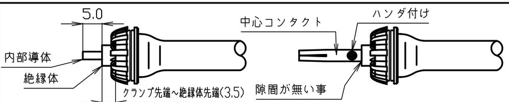
③ 絶縁体を指定の寸法で切り取り、中心コンタクトをハンダ付けするハンダ付けの後、中心コンタクトを手で引張り抜けない事を確認する
