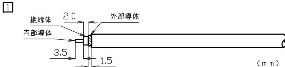
同軸ケーブルを図中の寸法で切り取る。
